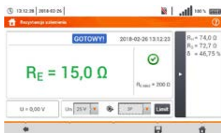
Měření odporu uzemnění
