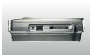
Boční připojení mini-USB kabelu a SD karty.
