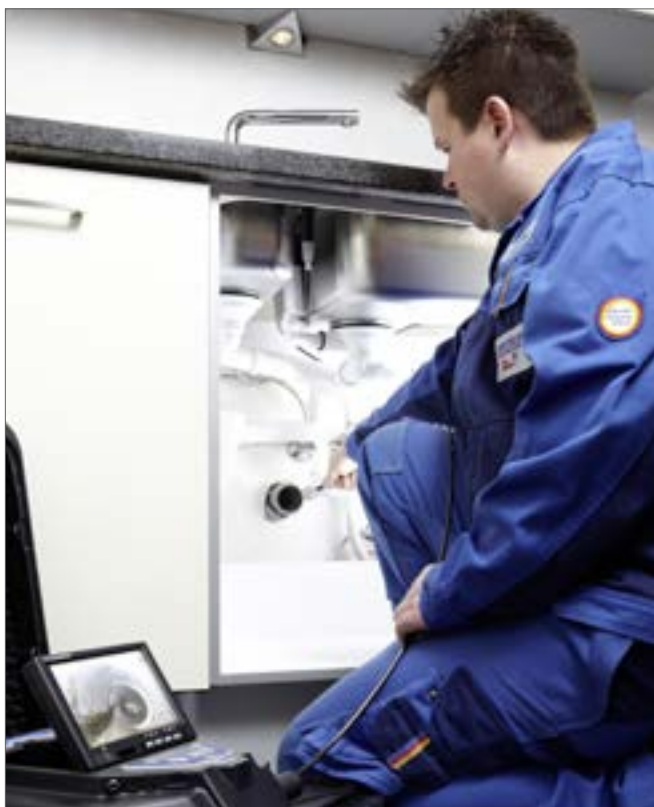
Barevná kamerová hlava, vodotěsná až do 3 bar, o Ø pouze 26 mm zvládne hravě ohyb 87° v potrubí od Ø 40mm.
