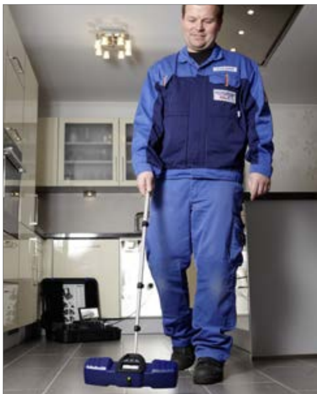
Na displeji se zobrazuje kromě digitálního počítání metrů také poloha kamerové hlavy. Radiolokace pomocí Wöhler L 200.
