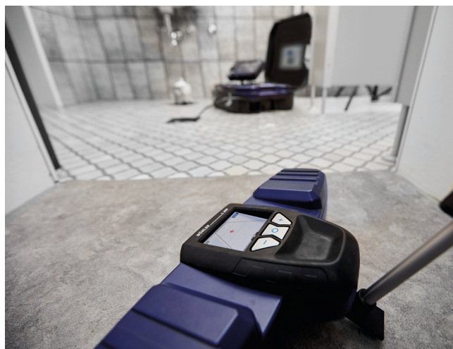
Díky Wöhler L 200 lokátoru může být poloha hlavičky kamery přesně určena.
